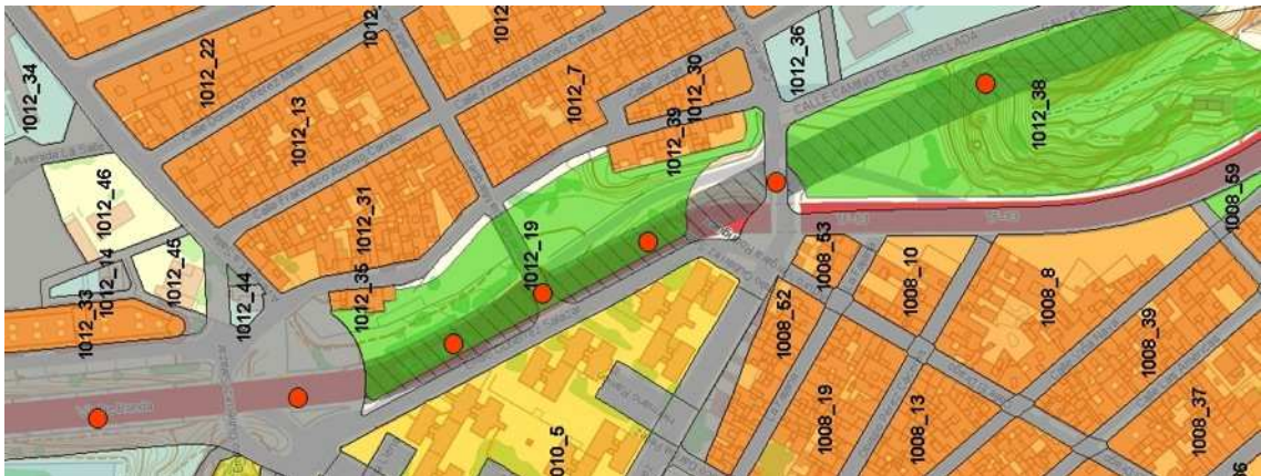
Figura 12: Ejemplo de superposición de pieza sobre tramos viarios. La vía de ronda este (sombreada en gris y rayada) queda cubierta en la propuesta de ordenación por la pieza 1012_19, calificada como sistema general de espacios libres públicos.
