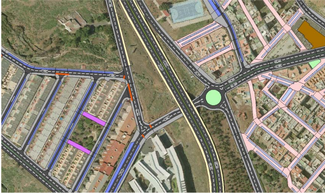
Figura T1-16: Desarrollo final de las vías de servicio de la TF-2
