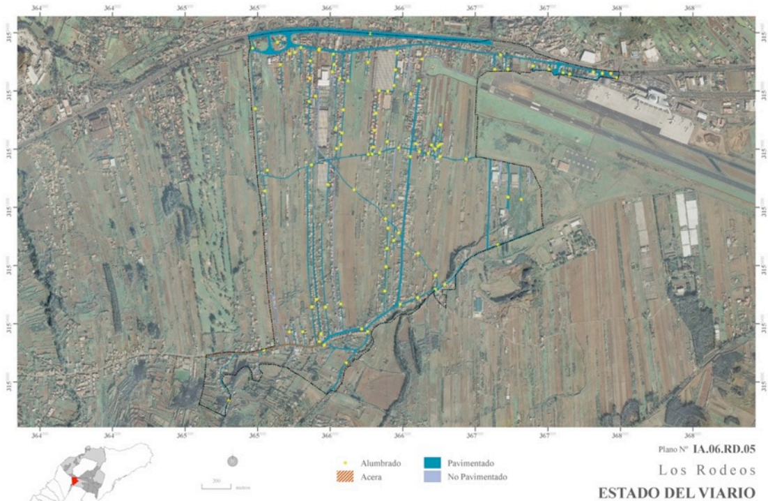
Figura 26: Plano del Avance (síntesis del Estado del viario)
