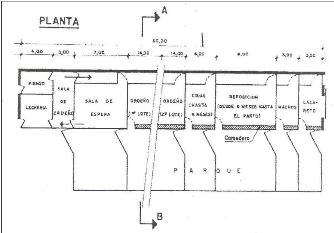
Figura 15.- Detalle tipo de la planta de una granja de cabras para 80 cabezas.
