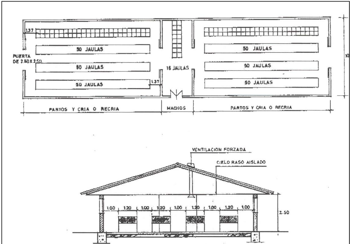
Figura 14.- Detalle tipo de una granja de conejos.
