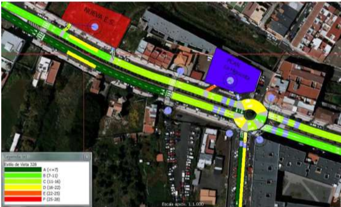
Nivel de Servicio de las vías (Densidad) observada tras la simulación de la propuesta
