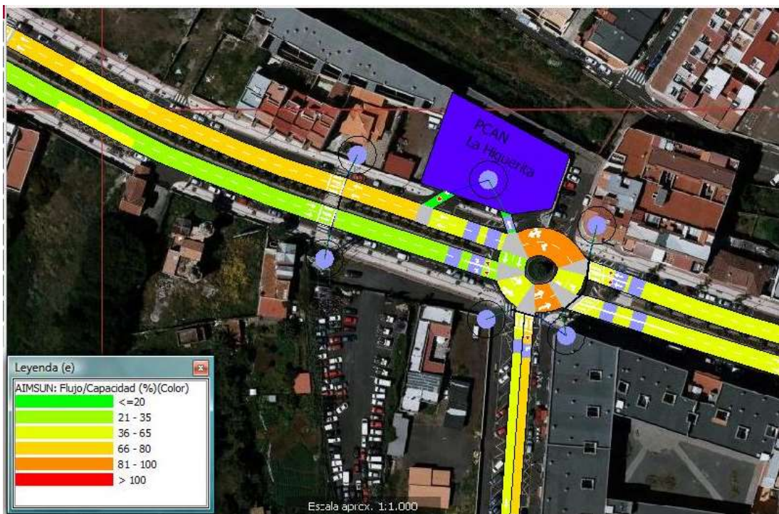
Nivel de congestión (Flujo/Capacidad) observada tras la simulación de la situación actual
